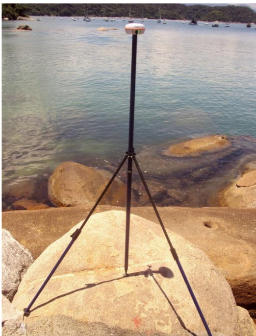
Figura 3 – Estação 93520 do IBGE utilizada como base de campo, em Angra dos Reis (RJ).
