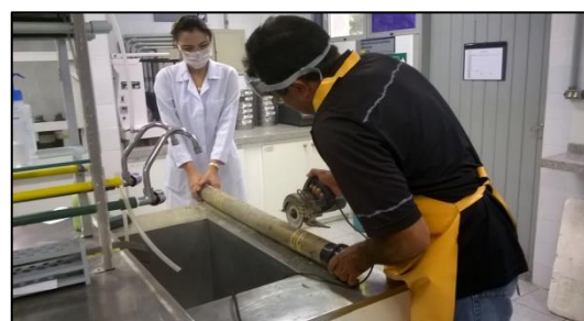
Figura 2 – Abertura do testemunho liner .
